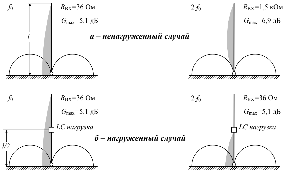
Рисунок 1 – Особенности нагруженных антенн: a – четвертьволновый вибратор длиной l без нагрузки на резонансных частотах f_0 и 2 \cdot f_0 ; б – четвертьволновый вибратор с нагрузкой ( l/2 – место включения нагрузки) на резонансных частотах f_0 и 2 \cdot f_0 .
