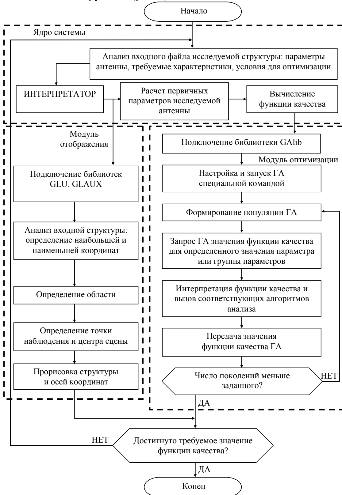
Рисунок 5 – Алгоритм работы программного обеспечения для моделирования проводных антенн с сосредоточенными нагрузками
