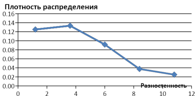
Рисунок 2 – Полигон распределения величины разностенности после первой вытяжки
