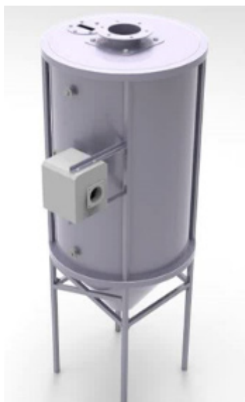
Рис. 1. Модель бункера для отволаживания зерна (патент на полезную модель № 174380)
