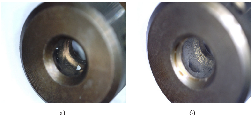
Рисунок 2 — Обработанная деталь — седло клапана: а) качественная поверхность; б) некачественная поверхность
