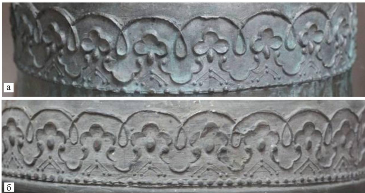
2.11 а. Орнамент, отлитый на колоколе заводе «П.И. Гилёва сыновей» (Тюмень), 2.11 б – тот же орнамент, отлитый на колоколе завода А.М. Кондакова (Тюмень).
