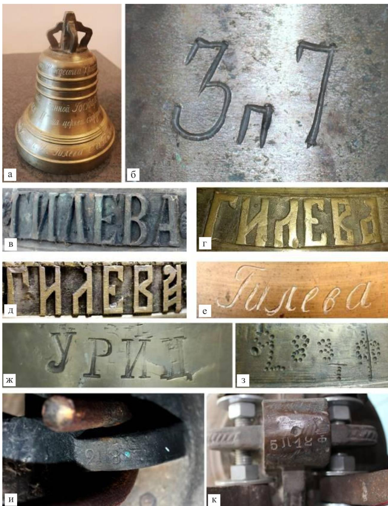
2.23. Примеры различных способов нанесения надписей и маркировки колоколов, обнаруженных в Сибири.
