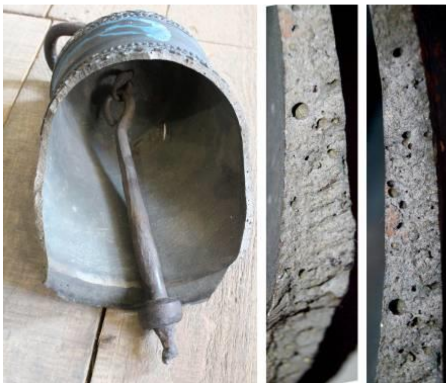
1.23. Поры в металле. Колокол завода «П.И. Гилёва сыновей». 1907 (?) г.
