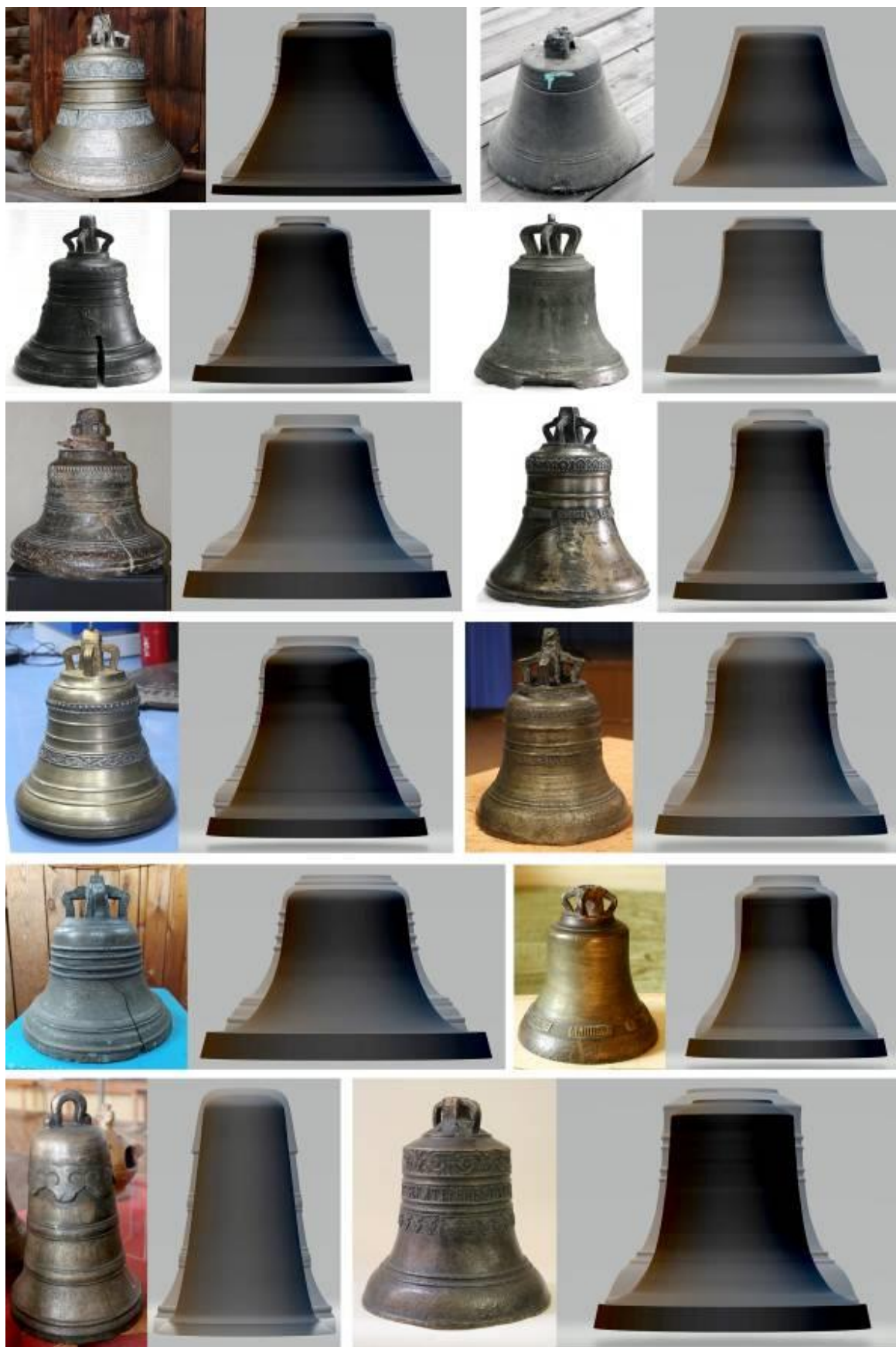
2.1. Профили колоколов различных заводов, обнаруженные в Сибири.
