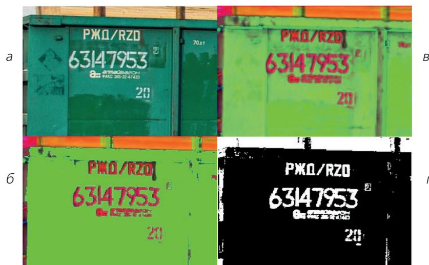
Рис. 1. Исходное изображение (а), преобразованное в HSV-формат (б), HSV-формат после наложения маски (в), бинаризация HSV (г)
