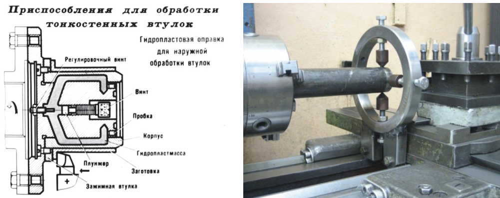
Рисунок 1 – Приспособления для обработки нежестких деталей
