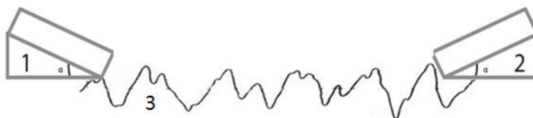
Рисунок 1 — Расположение излучателя и приемника: 1 — излучатель; 2 — приемник; 3 — шероховатая поверхность; \alpha — угол наклона
