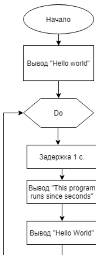
Рис. 3.5 Блок-схема программы Display a message on PC using UART.
